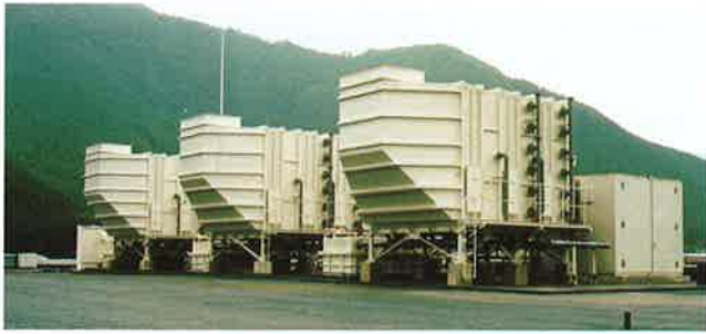
▲水平マルチステージスクラバー (2,000m 2 /min)
